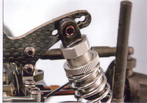
Viele Möglichkeiten, den Dämpfer an der vorderen Dämpferbrücke zu befestigen.
