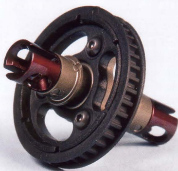
Das Spool für die Vorderachse. Die Ausgänge sind aus Aluminium.
